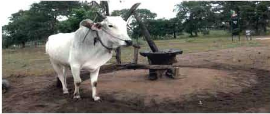
চিত্র: (দেশীয় পদ্ধতিতে) তেল ঘানিতে নিষ্কাশন।
